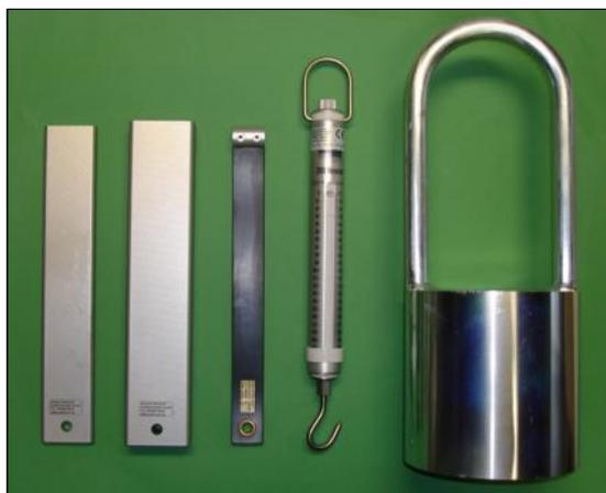
Prüfstäbe nach DIN EN 14752 und Prüfkörper nach VDV 111/ VDV 157 zur Erfüllung der Anforderungen im Prüfablauf der Schließkraftmessung.
