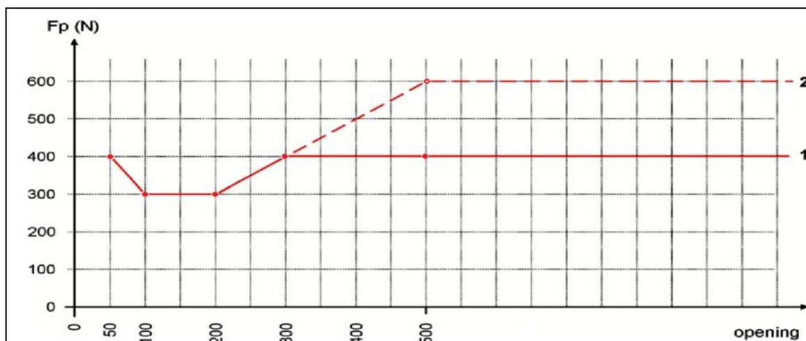
Graphique indiquant les forces maximales en fonction de l'ouverture de la porte. Le niveau supérieur de force (2) est orienté pour les véhicules à haute densité de circulation. L'utilisation de ce niveau élevé de force doit être indiquée dans les spécifications techniques par l'utilisateur.
