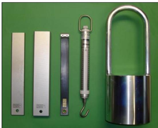
Peson selon EN 14752 et échantillons de poids selon VDV 111 / VDV 157 pour l'accomplissement des exigences de la séquence de test de force de fermeture.
