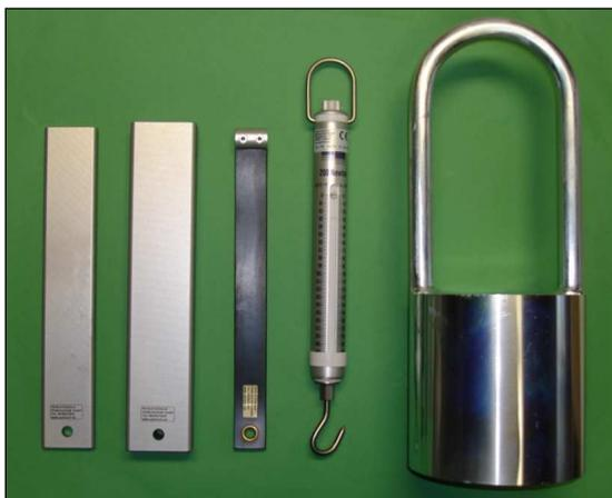
Prüfstäbe nach DIN EN 14752 und Prüfkörper nach VDV 111 zur Erfüllung der Anforderungen im Prüfablauf der Schließkraftmessung.
