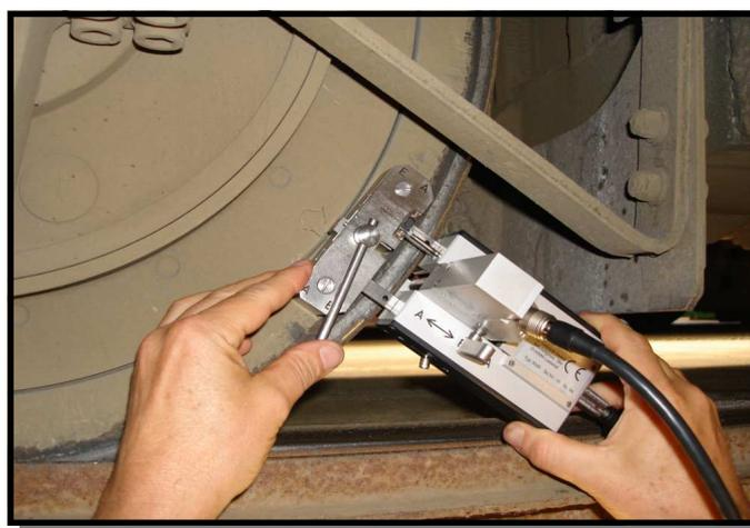
Es wurde sehr viel Wert darauf gelegt, dass der Messvorgang schnell und einfach durchgeführt werden kann. Die Messdaten werden mit dem von uns eingesetzten Handheldgerät PSION WORKABOUT sofort erfasst und optisch dargestellt.
