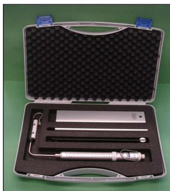
Koffer für Prüfkörper 1 bis 3 und Federwaage
