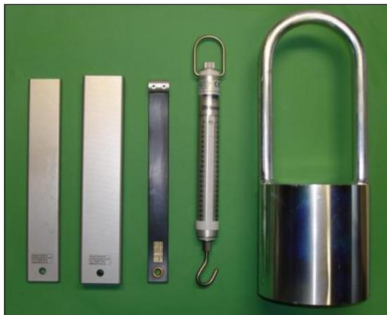
Prüfstäbe nach DIN EN 14752 und Prüfkörper nach VDV 111/ 157 zur Erfüllung der Anforderungen im Prüfablauf der Schließkraftmessung.
